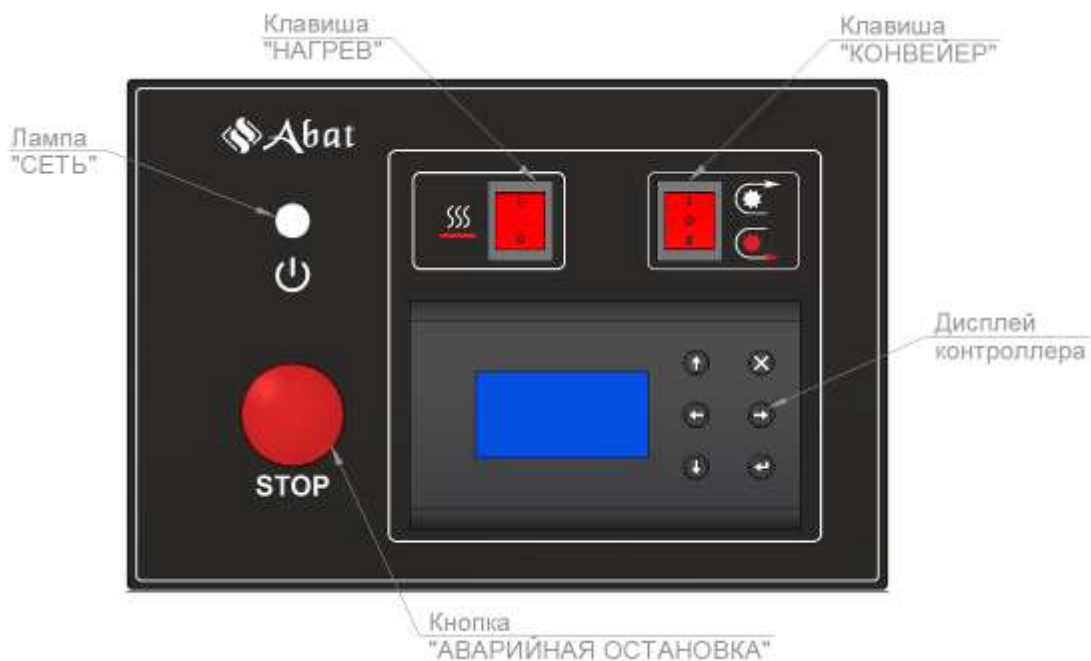
Рис. 7 - Панель управления ПЭК-800
